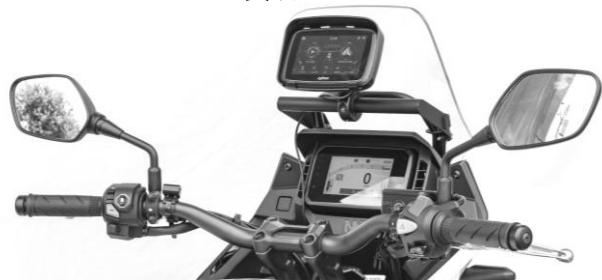
4、反対側はスクリーンを引張りながら、穴位置に合わせて、手順3同様に固定し完了です。 (写真D参照)
