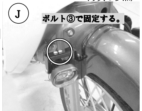
I <フロントキャリア併用時> カラー/平ワッシャー⑬/ キャリア/ボルトで固定。
