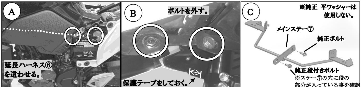
1、シート/左側のサイドカバーを取外し、延長ハーネス⑥をプラス→マイナスの順に取付けます。一時的にバッテリーのマイナスを外し、ショートしない様に絶縁します。手順15で再度、取付けます。(写真A参照)
