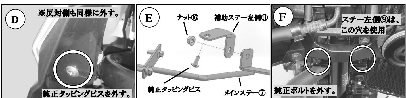
5、くちばしの裏側の両サイドのタッピングビスを取外す。※反対側も同様に取外す。 (写真D参照)
