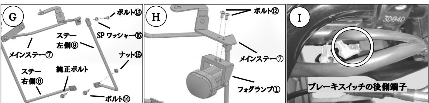
8、ステー右側⑧は、純正ボルトで仮固定します。 (図G参照)
