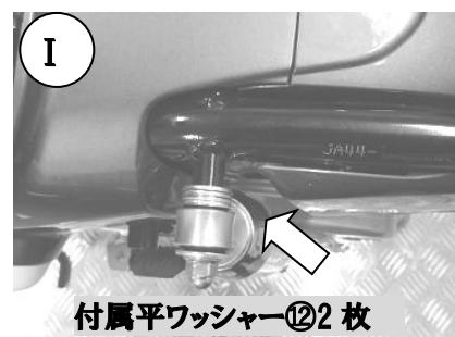
5、付属ロック受けステー⑩を付属M6フランジナット⑪で仮固定します。
