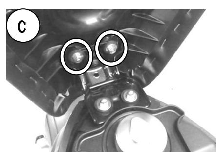
1、ボルト2本とリアショック固定ナットを緩め、純正リアキャリア/リアショックを取り外します。
