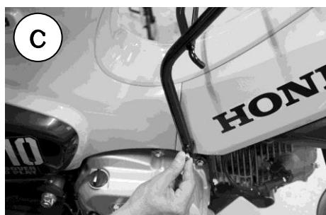
1. 左右のフレームカバーを固定しているボルトを外します。
