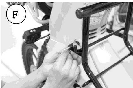
3. 車体右側から取り付け上部に付属カラー②をセットして本体ステーの穴と取り付け部の穴を合わせて付属ボルト⑥で仮止めします。 (写真D/E参照)
