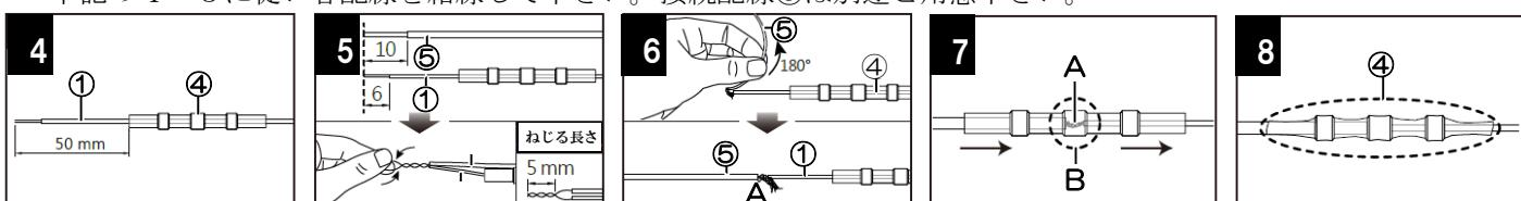
4:ランプの配線①を熱収縮チューブ④に50mmほど差し込みます。
