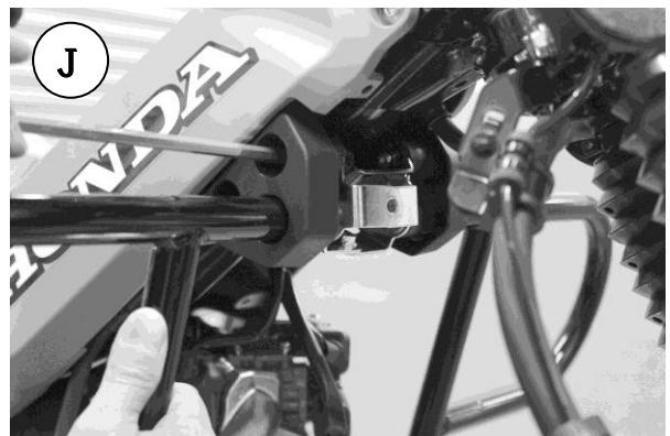
8. フロントプレートを仮止めした本体①/②を純正ボルトで車体に仮組みして行きます。
