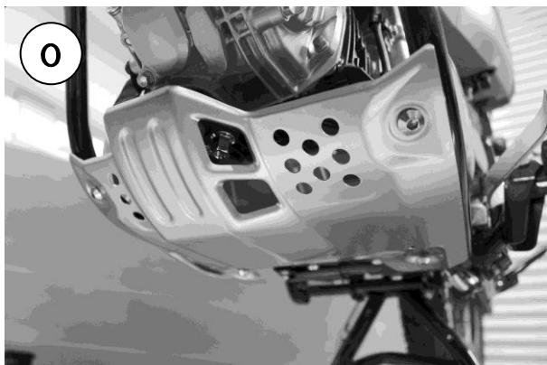
11. アンダープレート固定の四か所を純正ボルトで締め付けて完了です。
