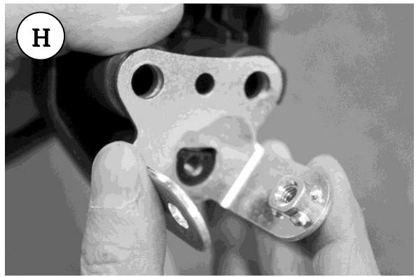
7. 本体①/②にフロントステーカバー、フロントプレートの切欠きを合わせて純正ボルトで仮止めします。
