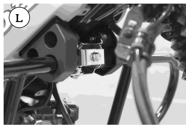
9. 車体に仮組みした本体①/②のフロントプレート固定ボルトを本締めしてから各部のボルトを本締め
