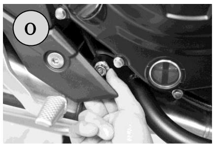
9、挟み込んだカラー④と本体②をプラハンなどで位置出しを行って純正ハンガーボルト/ナットで仮止めします。
