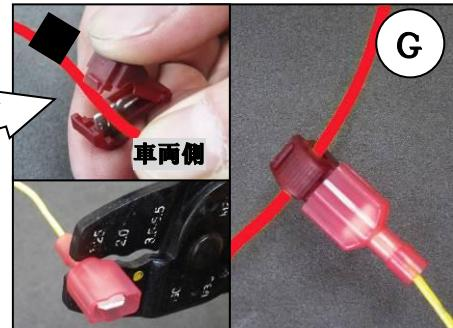
●電源ハーネス⑧を配線が噛み込み等で断線しない様に車両側に這わせます。
