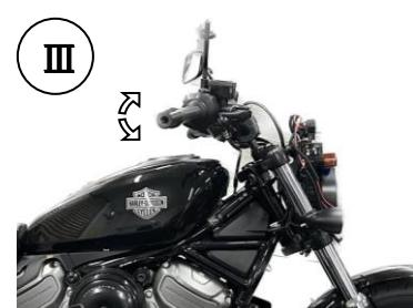
1、フォークアッパークランプ裏のボルトを取り外し、フォークアッパークランプからライザーコードを外します。
