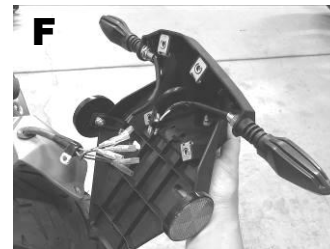
○ギボシ端子をすべて外す リフレクターも外します
