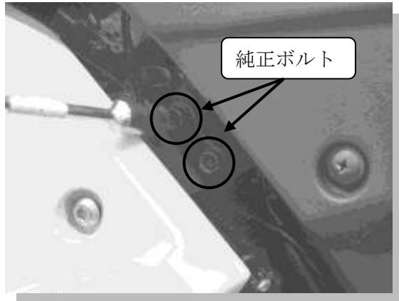
3 2で外したカウルステーボルトを付属のボルト④に換えて本体を共締めします。
