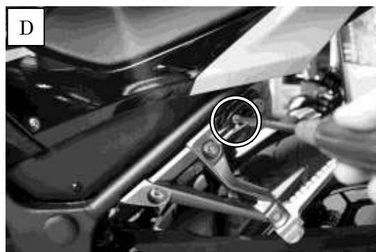
3. ヘルメットロック本体①を付属ボルト③を使用して取り付けます。 (写真D参照)
