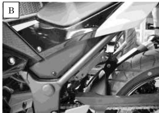
1. 進行方向左側のタンデムステップブラケットを外します。 (写真A、B参照)
