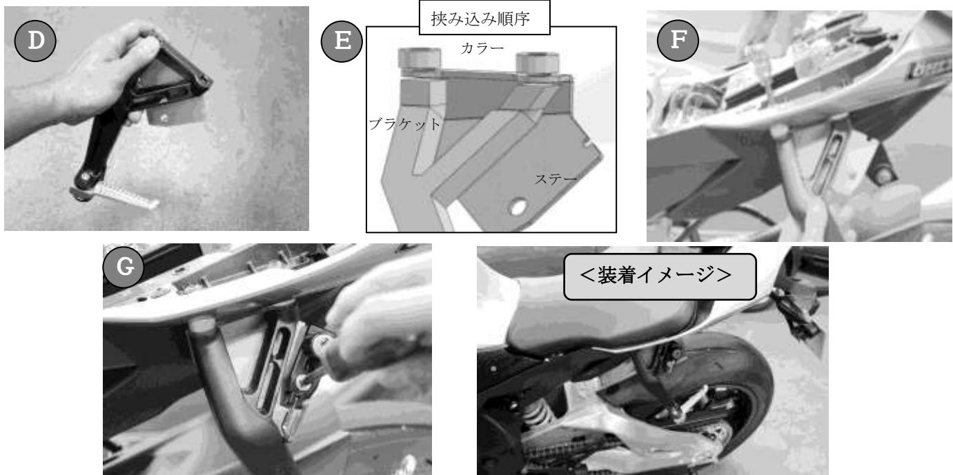
3. 外した左側タンデムステップブラケットにステー③、カラー④をセットして純正ボルトでフレームに固定します。
